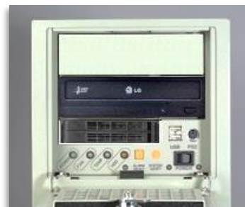
HDDフロント面交換(RAID対応)
